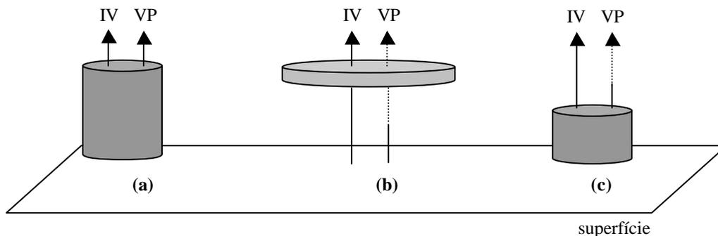
Figura 1 - Esquema ilustrativo das radiações ascendentes detectadas pelo satélite nos canais IV e VP para três tipos de cobertura: a) nuvem baixa e profunda b) nuvem alta e rasa c) nuvem baixa ou média de topo relativamente baixo.
